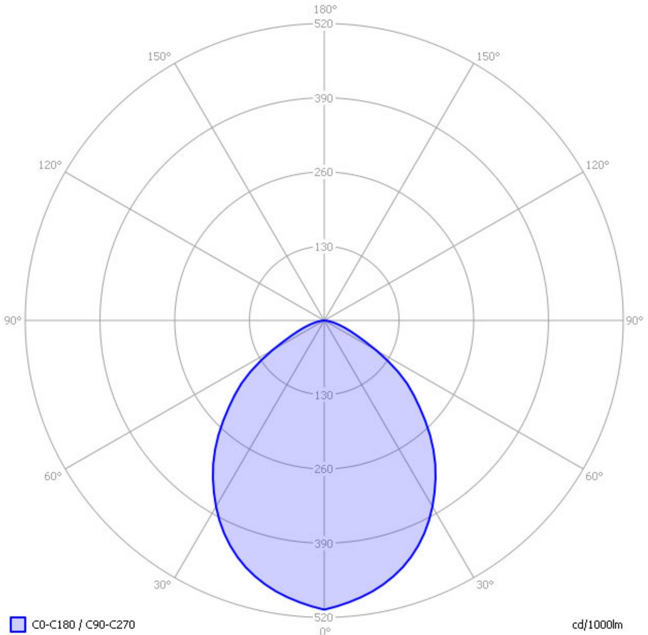
Das Lichtdiagramm für die beiden C Flächen.
