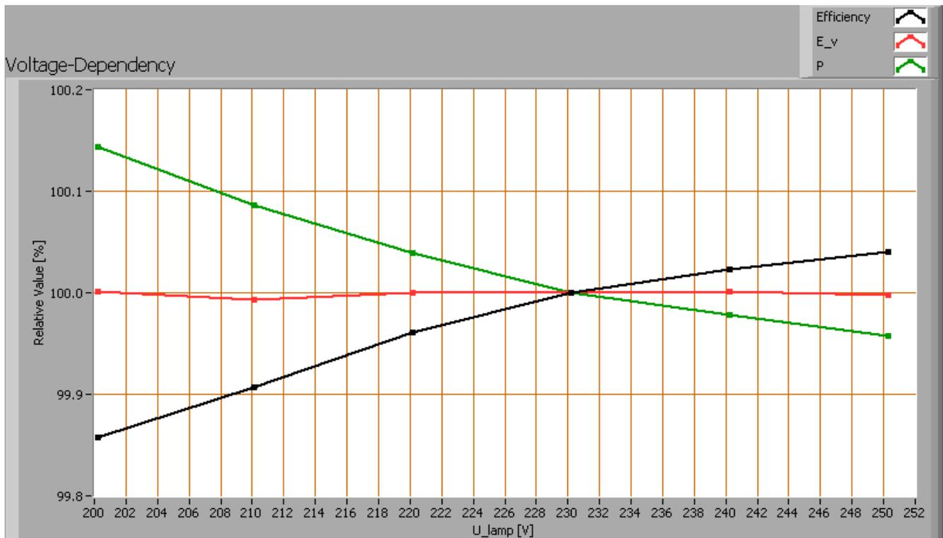
*Abhängigkeit von Lampenparametern von der eingestellten Lampenspannung.*
