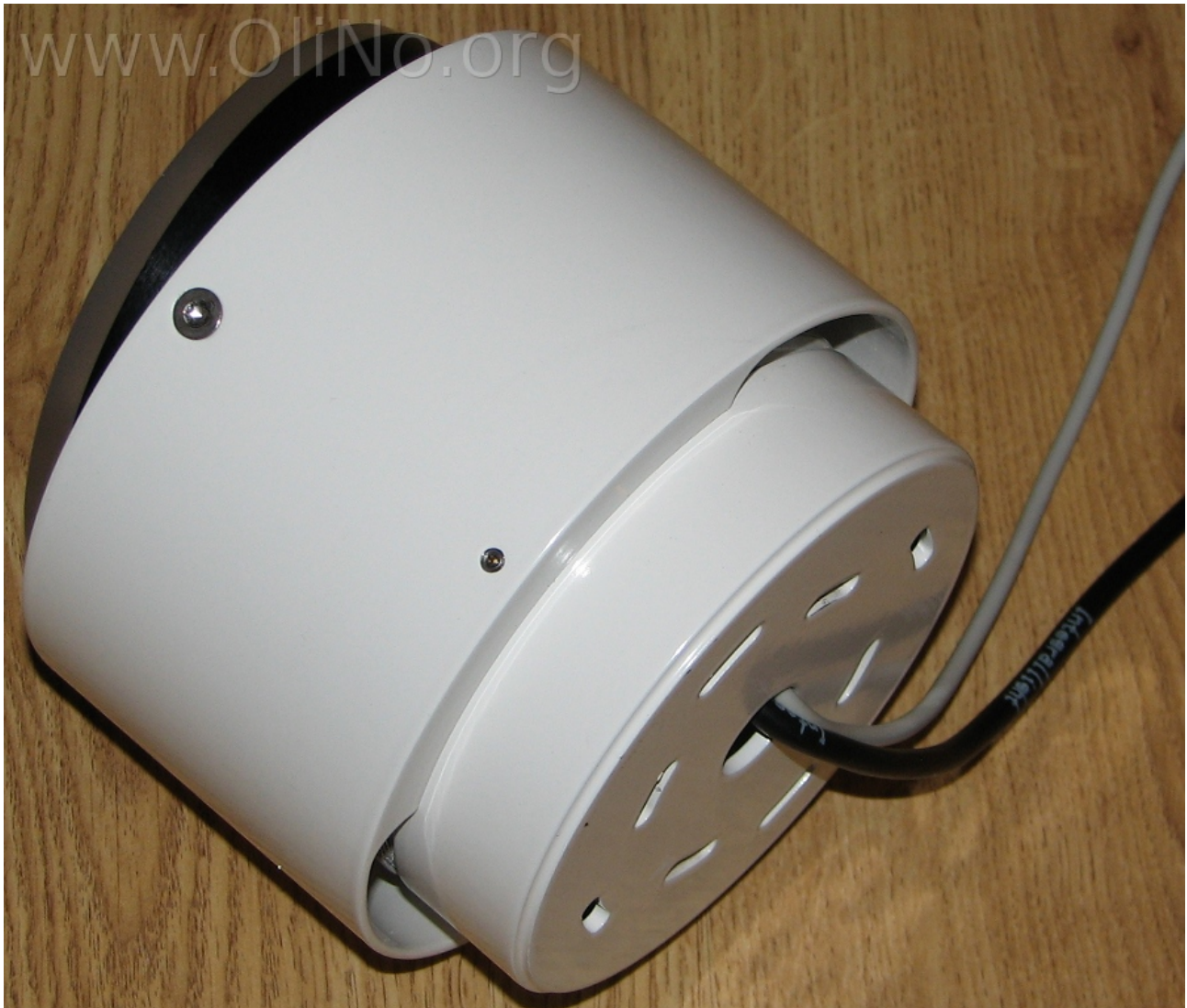
Zijaanzicht, met iets gekantelde led-schijf en de aansluitdraden (dim + 230 V)
