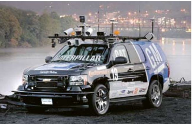
Deze auto won in 2007 de DARPA Urban Challenge. De auto’s moesten bij deze wedstrijd zelfstandig 100 kilometer door een stadse omgeving afleggen, waarbij ze uiteraard rekening moesten houden met de verkeersregels en met de andere weggebruikers.
