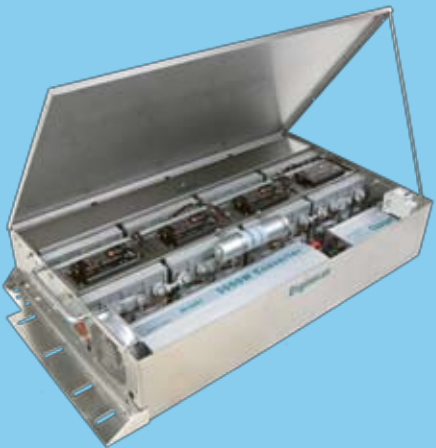
Wie niet wil wachten en handig is kan voor minder dan 2.000 euro zelf deze 4kWh set van Enginer importeren en inbouwen. De Prius gebruikt de eerste 50 kilometer na opladen dan ongeveer half zoveel benzine.
