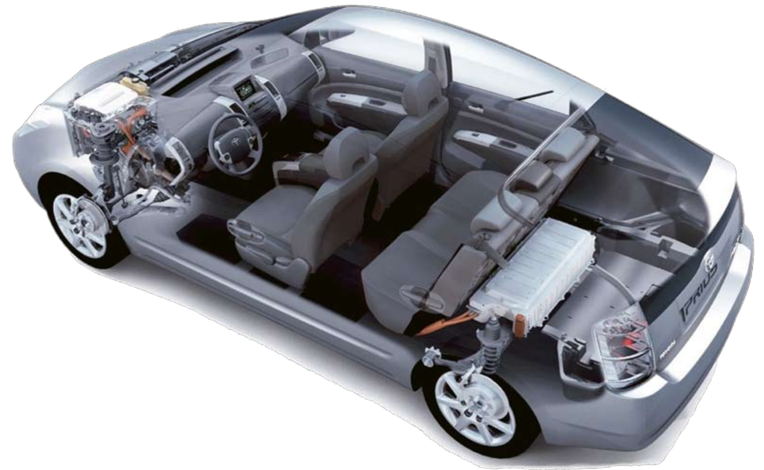
Een uitsnede van de Toyota Prius. Linksvoor is de elektromotor zichtbaar en rechtsachter de batterij.
