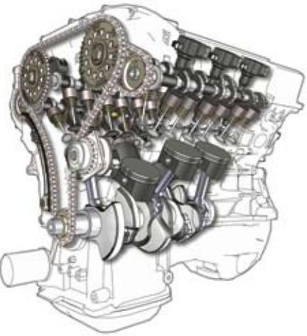
De belangrijkste bewegende onderdelen van een benzinemotor. Zij zetten de kracht van de explosies om in een ronddraaiende beweging van de aandrijfas onder in het plaatje.
