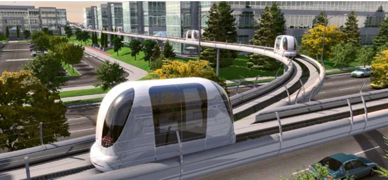
Londen is bezig met een systeem dat ULTra (Urban Light Transport) is gedoopt. ULTRA lijkt op een metro in de zin dat het een eigen “spoor” heeft met vaste “stations” waarop je in- of uitstapt. Maar het werkt met losse auto's die over een gewoon wegdek rijden. De auto rijdt weg zodra je bent ingestapt en zijn er geen tussenstops. 98
