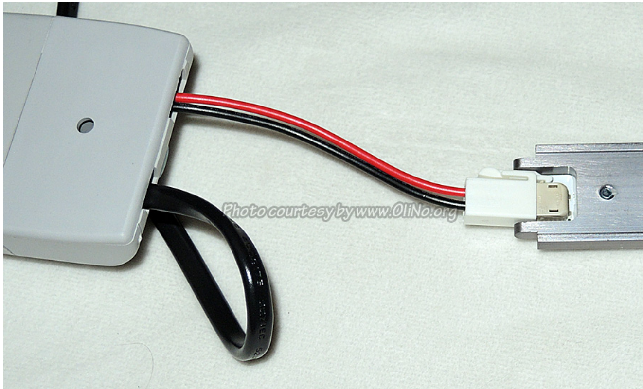
Verbinding tussen voeding en strip.
