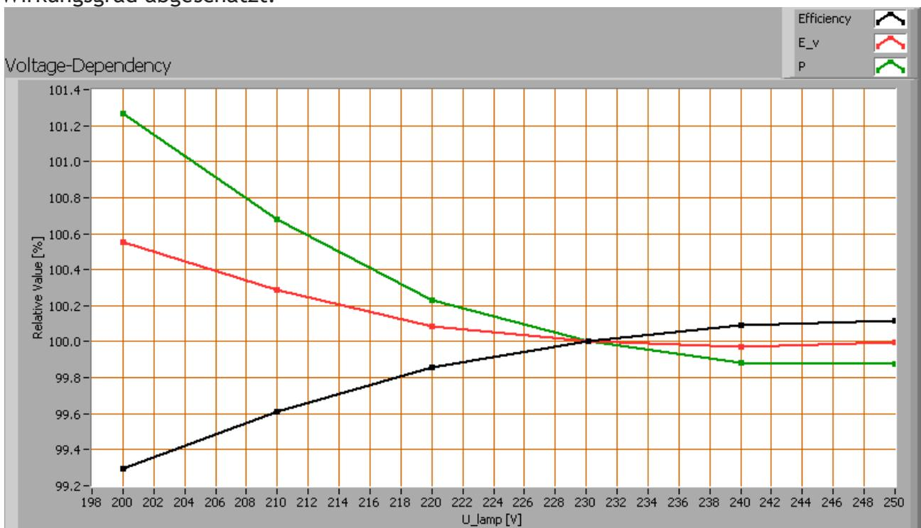
*Abhängigkeit von Lampenparametern von der eingestellten Lampenspannung.*
