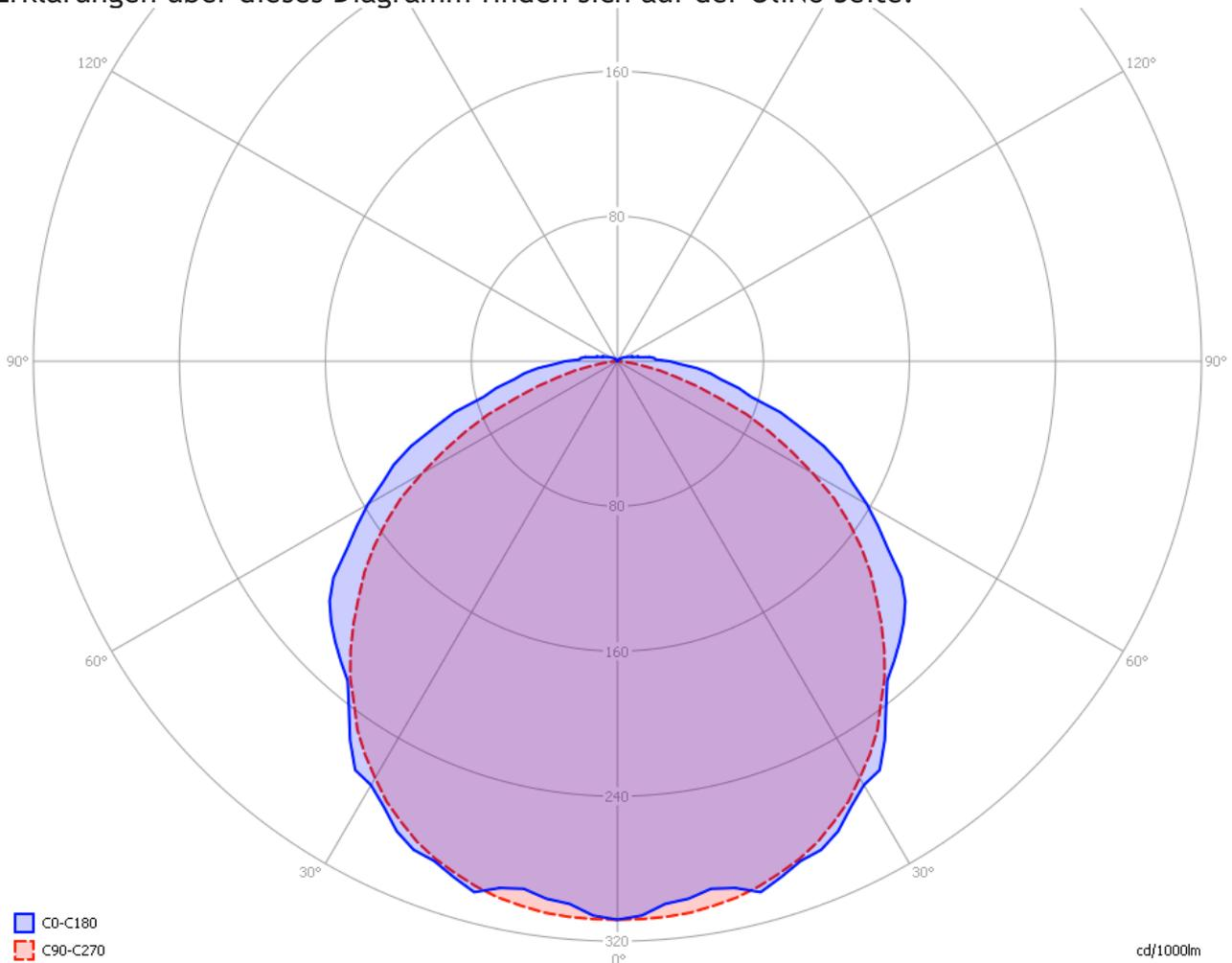
*Das Lichtdiagramm für die beiden C Flächen.*
