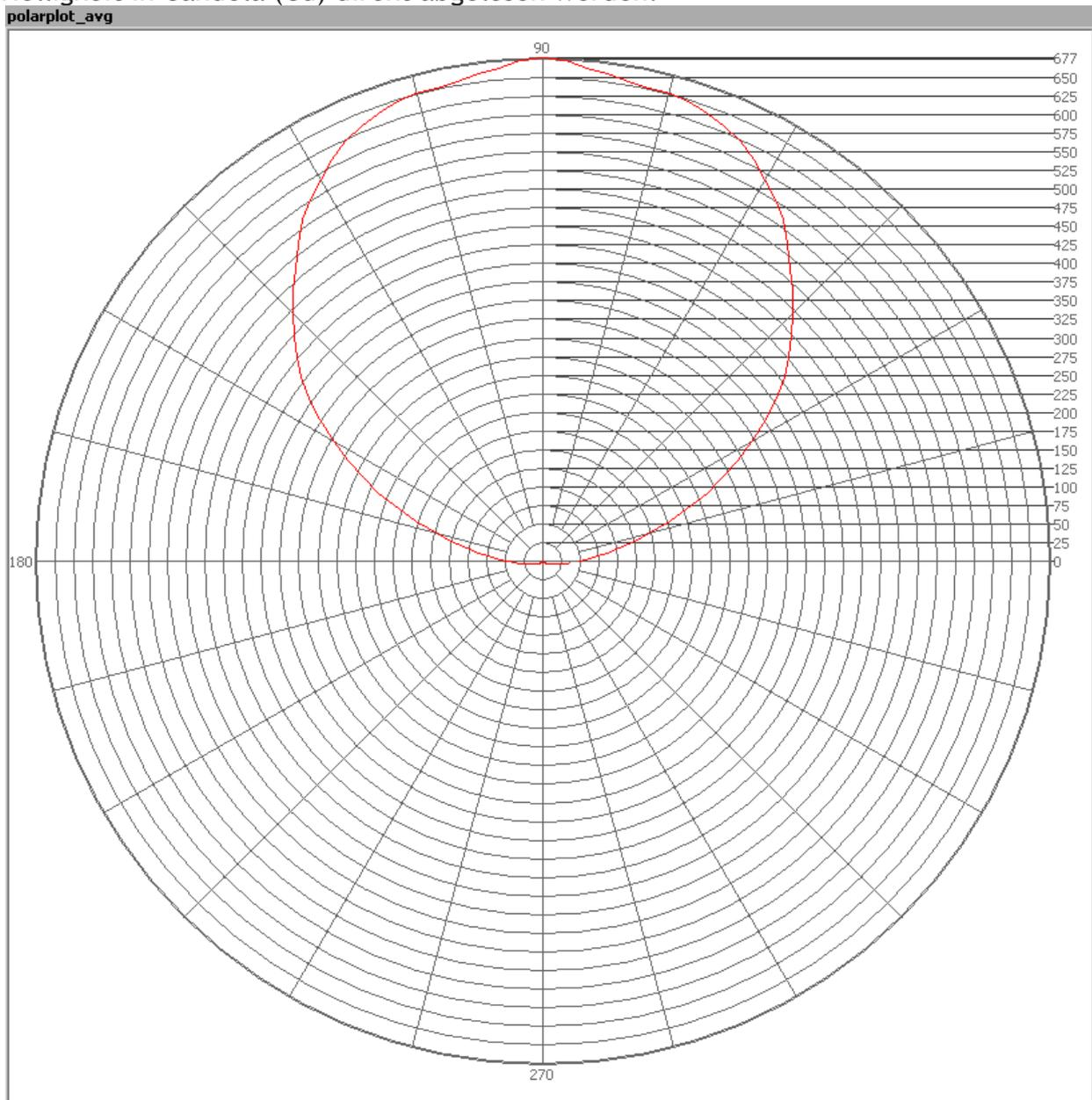
Das Strahlungsdiagramm der Lampe.
