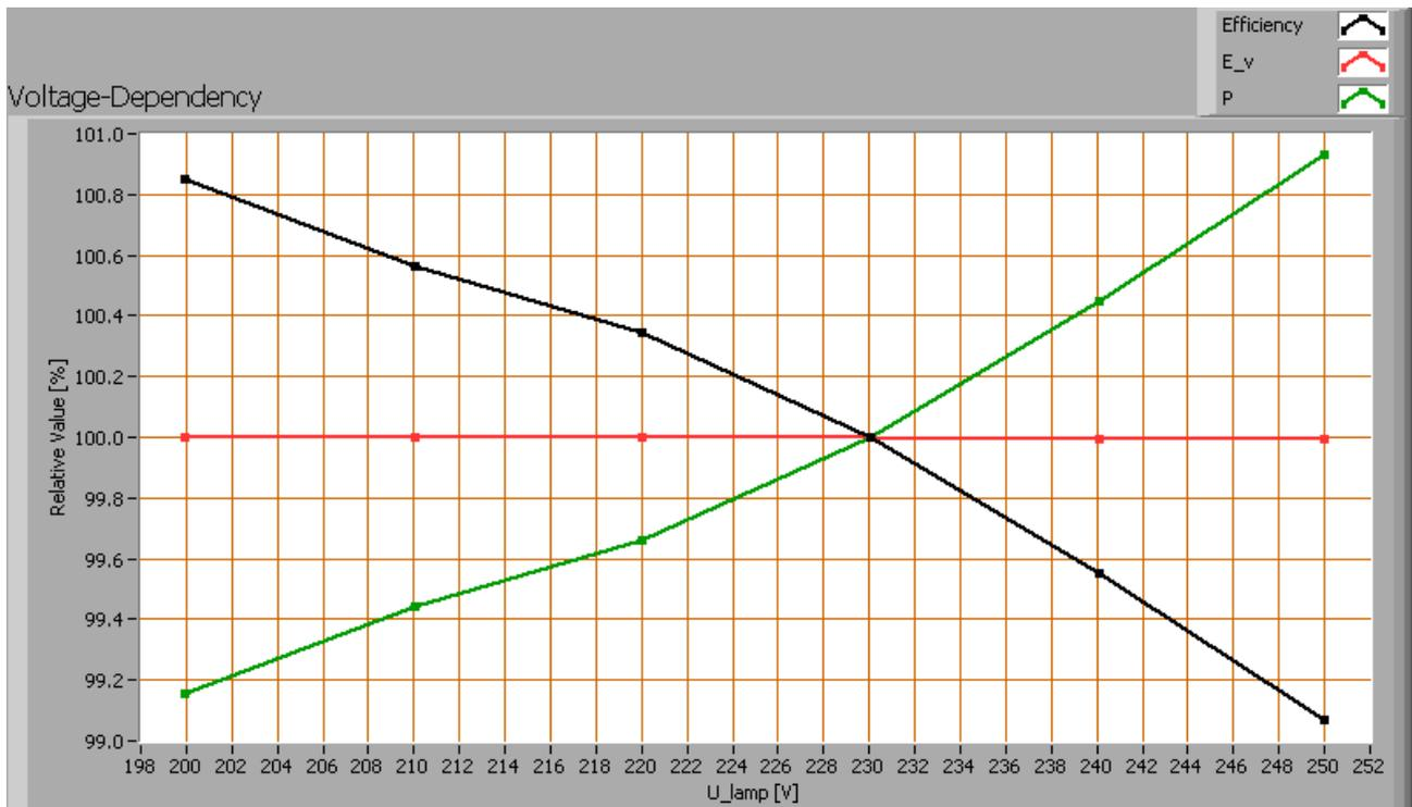
*Abhängigkeit von Lampenparametern von der eingestellten Lampenspannung.*
