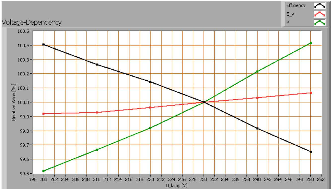
*Abhängigkeit von Lampenparametern von der eingestellten Lampenspannung.*
