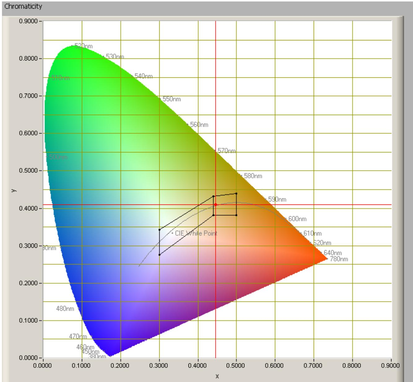
*Farbdiagram und Farbe des Lichtes dieser Lampe.*
