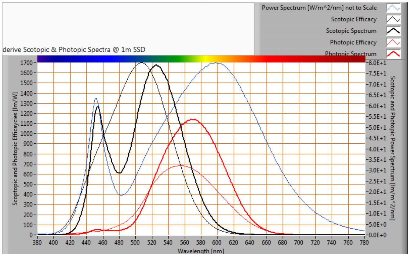
*La puissance spectrale, les courbes de sensibilité, et les spectres de jour et de nuit en résultant (ces derniers obtenus à 1 m de distance).*
