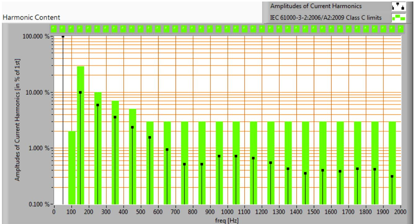
*Les oscillations du courant, augmentées des exigences pour oscillations comprises dans IEC61000-3-2:2006 A2:2009*
