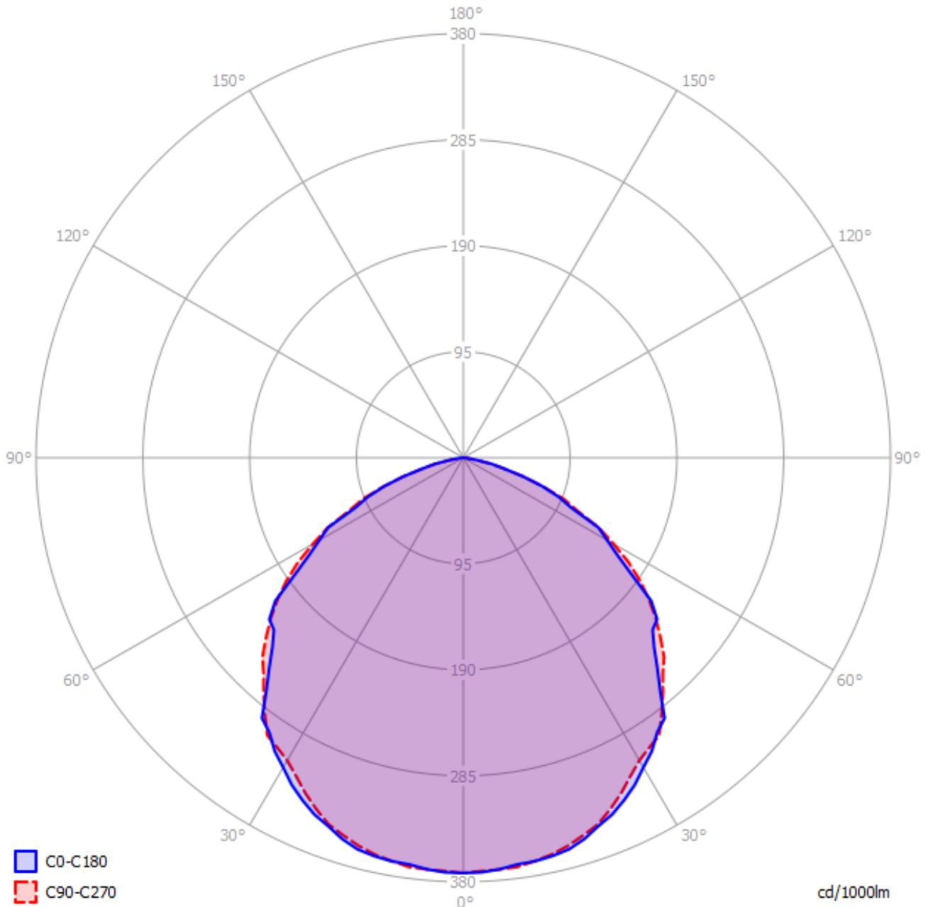
Das Lichtdiagramm für die beiden C Flächen.
