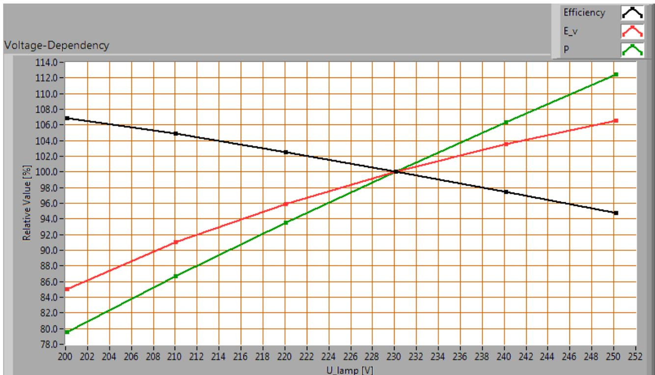
*Abhängigkeit von Lampenparametern von der eingestellten Lampenspannung.*
